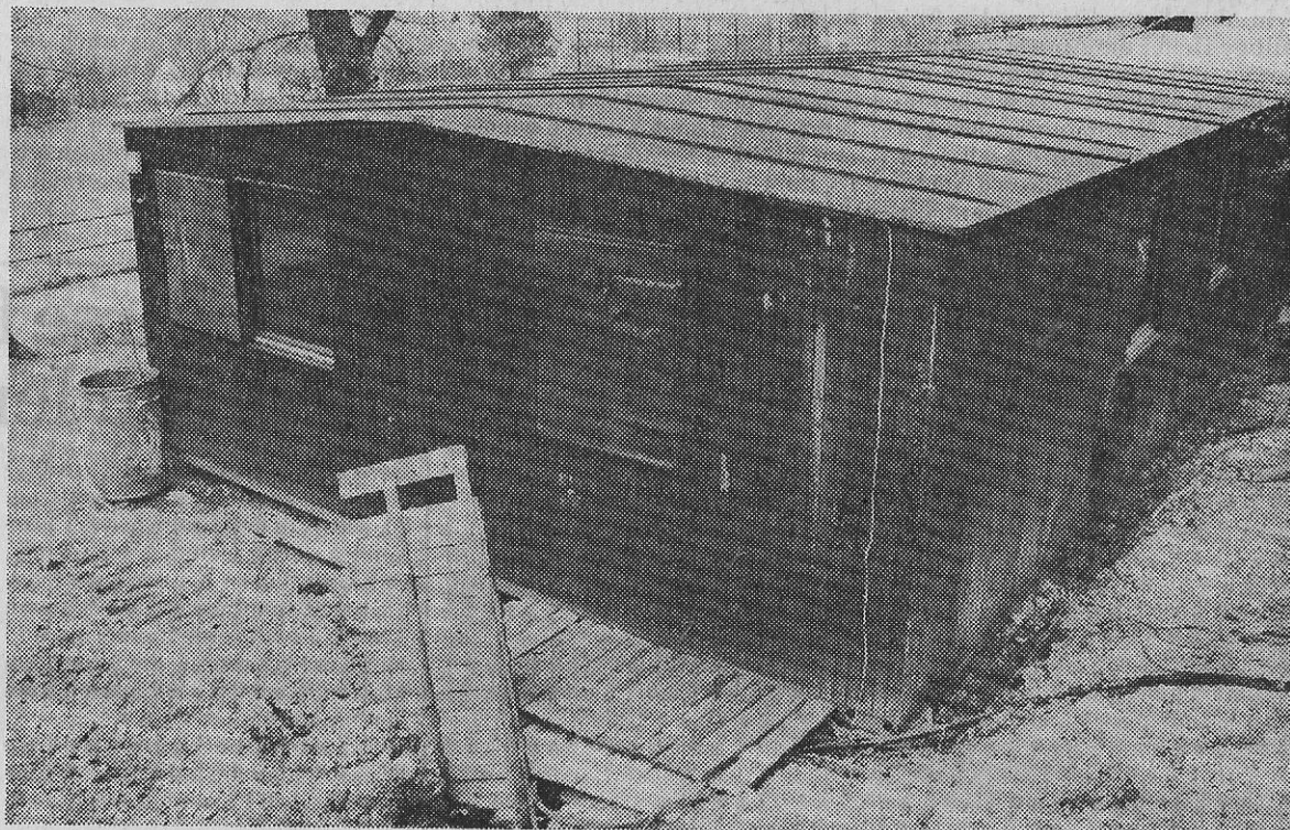
Diesen gebrauchten Büro-Container will der SC Dombach zum provisorischen Sportlerheim umbauen. Wasser- und Kanalanschlüsse sind bereits gelegt, für den Einbau der Heizung ist aber eine Baugenehmigung nötig.
